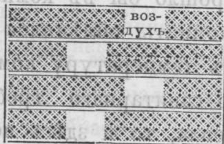
Для провѣрки теплопроводности таковыхъ стѣнъ мною была устроена печь, одна стороны топки которой была сложена въ 2 кирпича обыкновенной кладки, а другая въ  $1\frac{1}{2}$  кирпича съ изолирующими каналами и при постоянной топкѣ температуры наружныхъ поверхностей стѣнокъ были таковы: стѣна въ 2 кирпича имѣла  $17$  и  $18^\circ$ , а стѣна въ  $1\frac{1}{2}$  кирпича съ каналами  $17\frac{3}{4}$  —  $18\frac{1}{2}$ .
